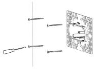
ELECTRICIAN INSTALLATION HOLD THE 13-AMA-PR AGAINST THE BRICK AND INSTALL FASTENING SCREWS INTO THE WALL PLUGS.
